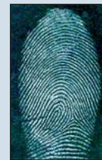
Los vapores de cianoacrilato reaccionan (se polimerizan) con agua y con otros elementos de las impresiones dactilares y forman un depósito duro blancuzco. Se pueden utilizar en la mayoría de las superficies no porosas y en algunas superficies porosas.
